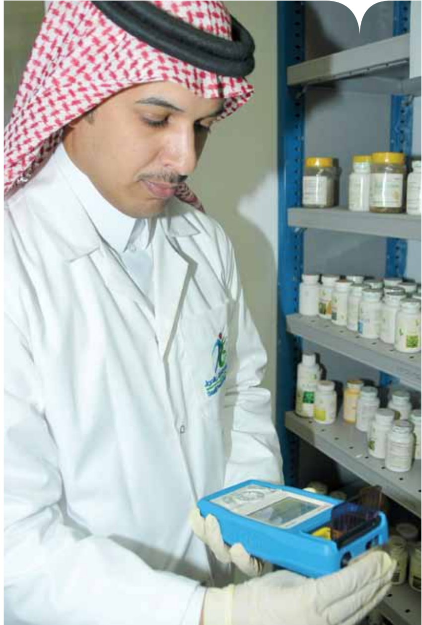
أحد موظفي الهيئة يفحص دواء بواسطة جهاز «رامان» ليعرف إذا ما كان مغشوشاً.
